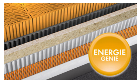
Aufbau einer Wand mit einer Putzträgerplatte aus Hanf.
